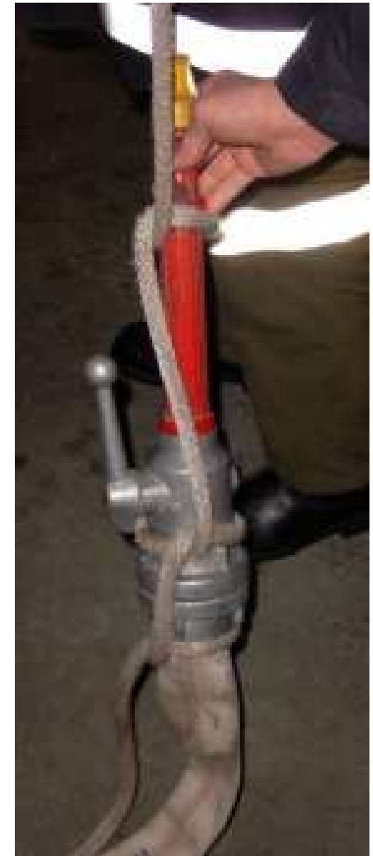
Aufziehen einer Löschleitung
