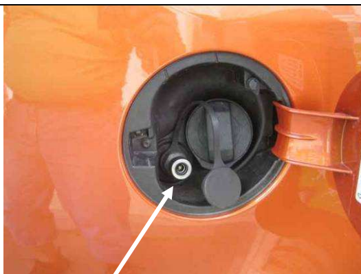
Erdgastankanschluss links neben „normalem“ Tankstutzen
